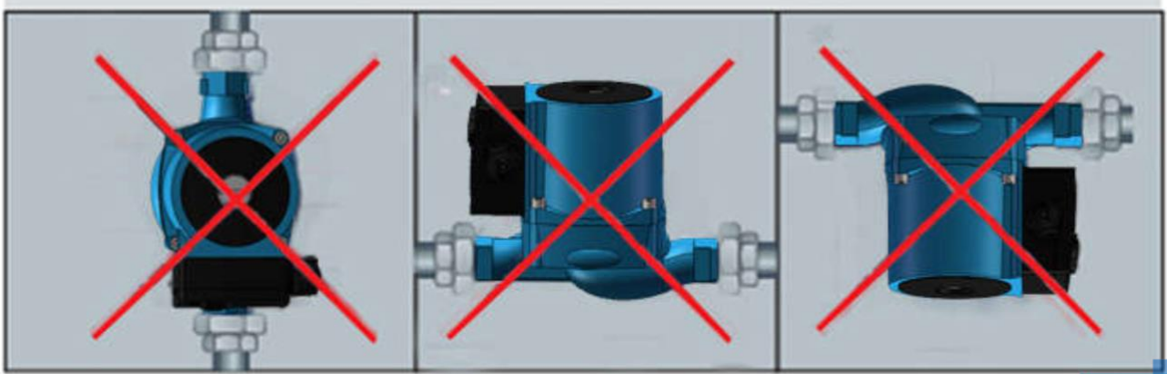
▼ Posição incorreta de instalação wrong installation position
